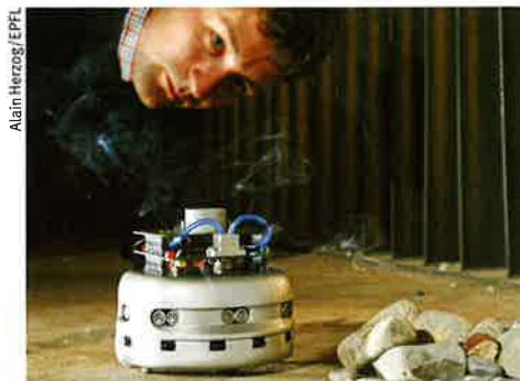
Thomas Lochmatter avec un modèle de robot capable de détecter des gaz.
